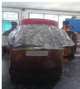
Gambar 2. Proses maserasi dengan etil asetat
